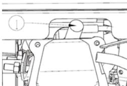
2. ハンドルバーをプラグレンチに差し込んでプラグレンチを反時計回りに回して点火プラグを取り外します。
