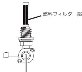
3. 燃料コックに取り付けられている燃料フィルター部を灯油で洗浄します。
