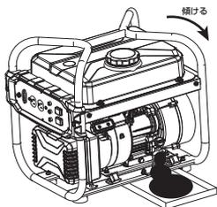
5. 新しいエンジンオイルを付属品のオイルジョッキを利用して規定量補給します。
