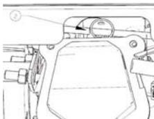
3. 点火プラグにすすやカーボンが付着していないか点検します。また点火プラグの焼け具合も点検し中間一明るい茶色であるか確認します。
