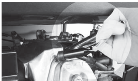
5. 掃除した点火プラグを取り付け、プラグキャップを取り付けてください。
