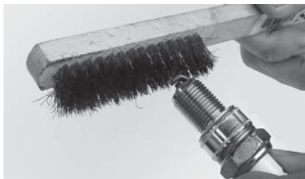
3. ワイヤブラシ等でプラグの電極部分を掃除してください。
