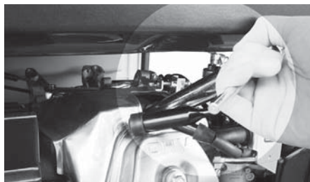
2. 付属のプラグレンチを使用して点火プラグを取り外します。
