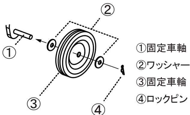
1.)発電機本体下部の車軸にワッシャー、車輪、ワッシャーの順で取り付けた後、固定車軸の穴にロックピンを通し、車輪が外れないように固定してください。
